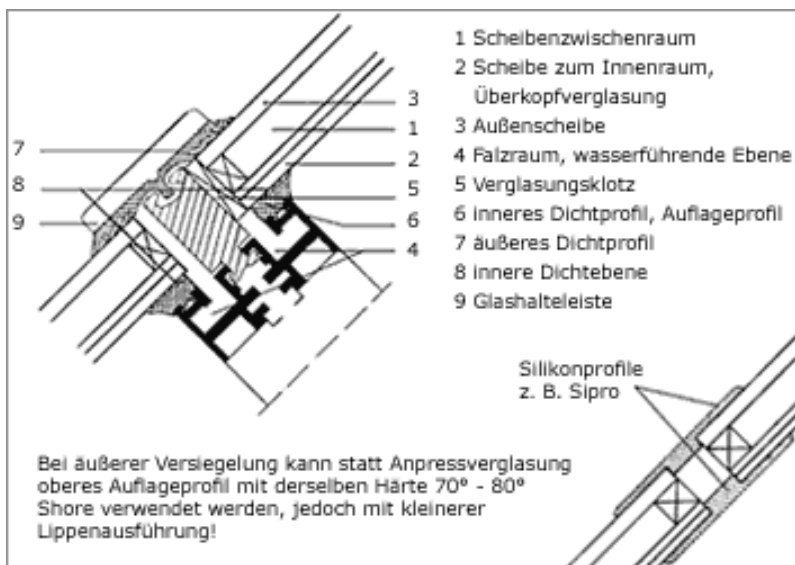
Schematische Darstellung: Anpressverglasung mit Dichtprofil z.B. Sipro 60° - 70° Shore
